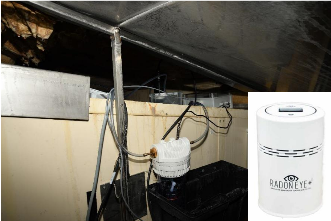
Photographie du système de mesure du radon dissous dans l'émergence épikarstique du SAS1 de la Grotte de Lascaux.
