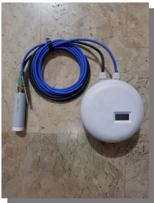
GMP251 – Vaisala CAN 24 bits Température pt100 Autonomie 2 mois
