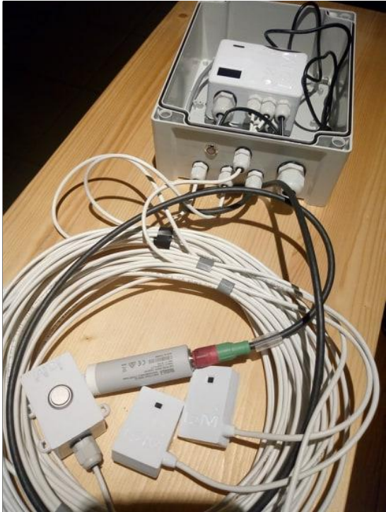
GMP251 - Vaisala CAN 16 bits Température Bouton poussoir Alimentation 12V
