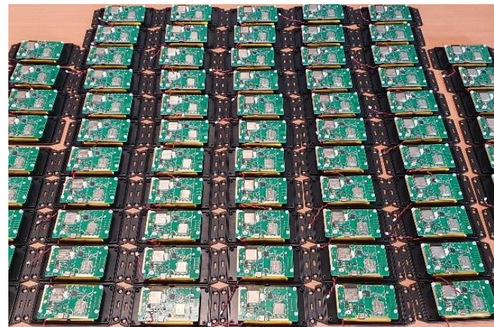
120 objets connectés autonomes pour le suivi et la gestion des emballages industriels consignés
