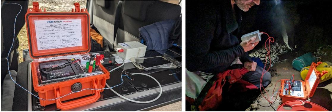
Figure 2 : Data Phone du Spéléo-Secours Français, à l'extérieur et à l'intérieur de la cavité
